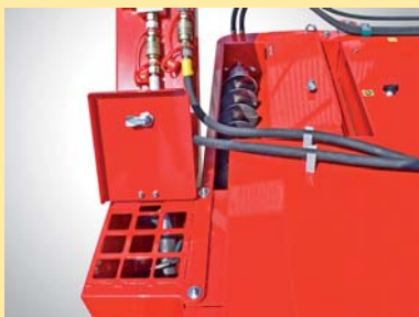
Förderschnecken zum Abtransport des Einstreumaterials; Geschwindigkeit einstellbar.
