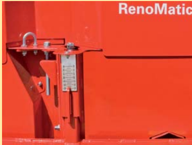
Arbeitstiefe der Federzinken-Wellen mehrfach exakt einstellbar
