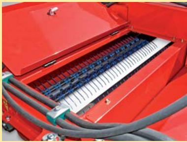
Rotierende Walzen, bestückt mit Federzinken zum schonenden Herausarbeiten des Einstreumaterials
